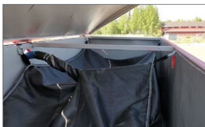
Geotextileinheit trennt effektiv Feststoffe von Wasser.
